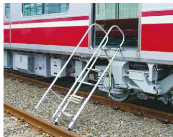
▲非常脱出ハシゴを設置した様子
